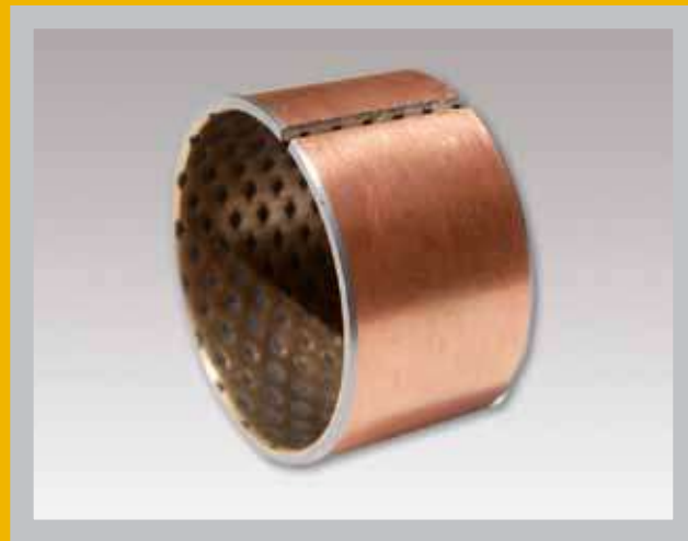
GEROLLTES VERBUNDGLEITLAGER, STAHL/BRONZE, GEFÜLLTE SCHMIERMITTELDEPOTS, WARTUNGSFREI
