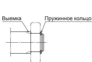
(а) Пружинное кольцо и заплечик с выемкой
